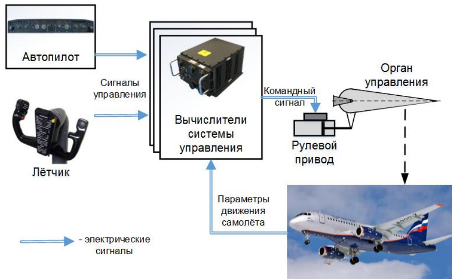
Рисунок 1.2 – Принципиальная схема ЭДСУ
