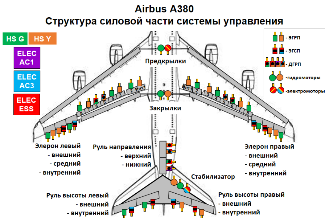
Рисунок 1.4 – Распределение потребителей системы управления по энергосистемам самолёта Airbus A380
