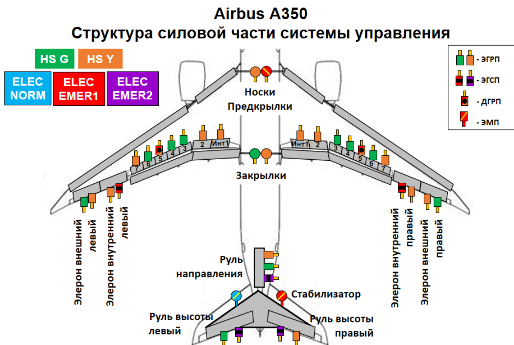
Рисунок 1.5 – Распределение потребителей системы управления по энергосистемам самолёта Airbus A350
