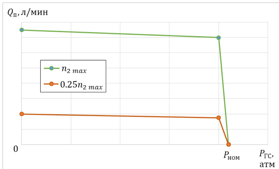
Рисунок 2.11 – Пример диаграммы зависимости подачи насоса от давления в гидросистеме и оборотов ротора высокого давления двигателя
