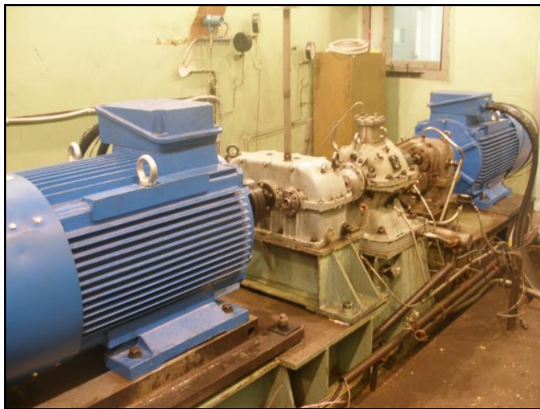
Рисунок 10 - Стенд Т14-15/1 для испытаний межроторных подшипников
