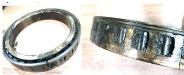
Рисунок 15 – Элементы подшипника после испытаний
