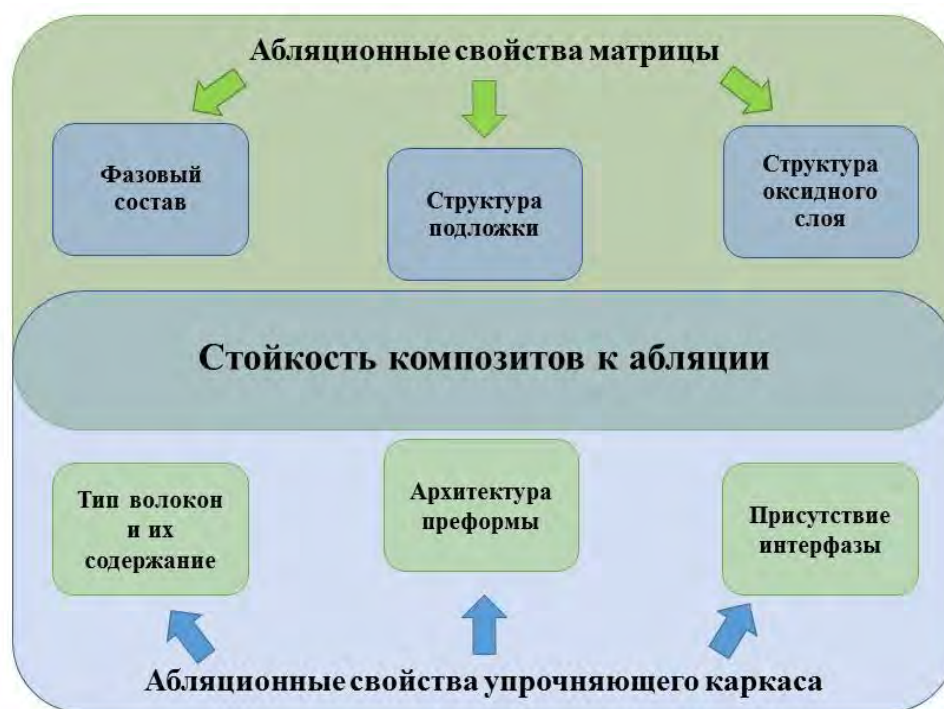
Рис. 1.2. Факторы, определяющие устойчивость УККМ к абляции
