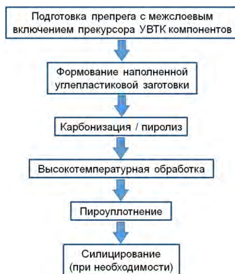
Рис. 3.1. Стадии техпроцесса изготовления изделий из УККМ с УВТК компонентами матриц
