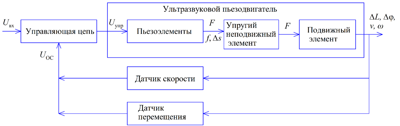
Рис. 3. Структурная схема УЗПД с датчиками обратной связи
