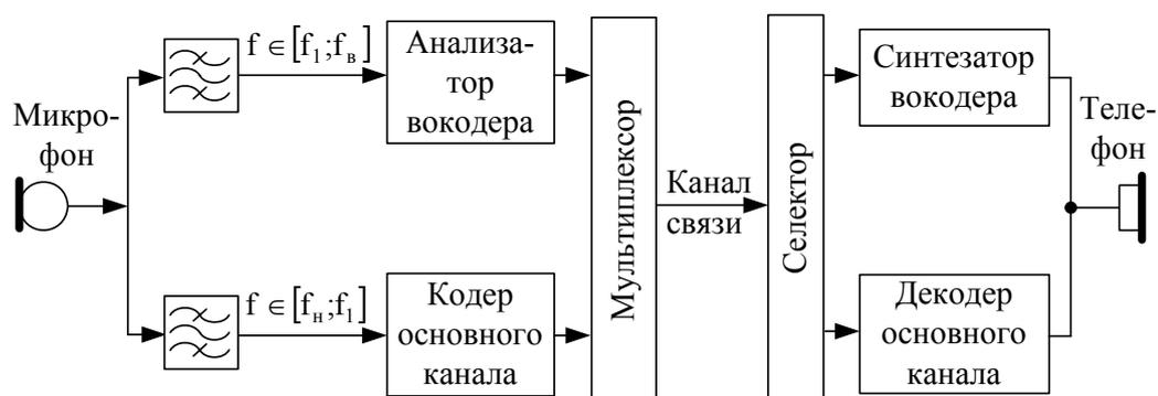
Рис. 1. Структурная схема полувокодера.
