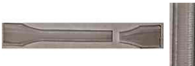
Рис. 2. Сплошные образцы из PLA, полученные с помощью заданного угла волокон при FDM-печати: расположение волокон под углом 90^\circ
