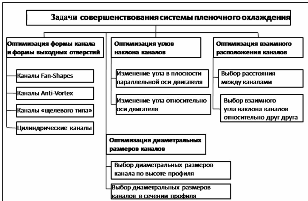
Рис. 6 - Основные задачи по конструктивному совершенствованию системы плёночного охлаждения лопаток современных и перспективных турбин ВРД.
