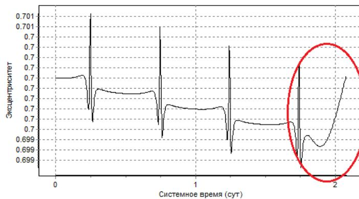
Рисунок 6.39 – Отработка компенсации ухода эксцентриситета
