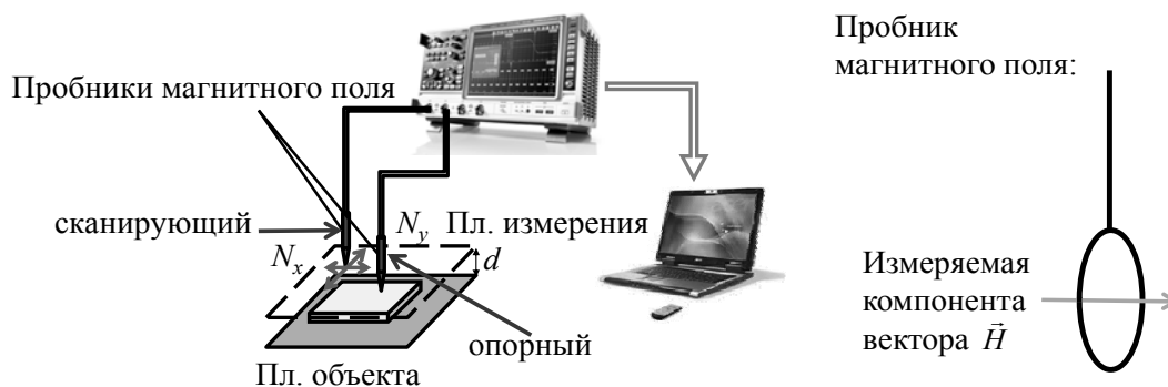
Рисунок 4 – Система измерения ПЭМИ СВТ в ближней зоне.
