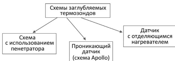
Рис. 3. Классификация схем заглубляемых термозондов
