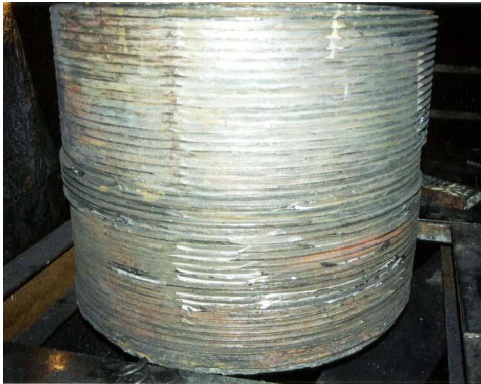
Рисунок 68. Частично корродированная внешняя резьба колонны 100 МН
