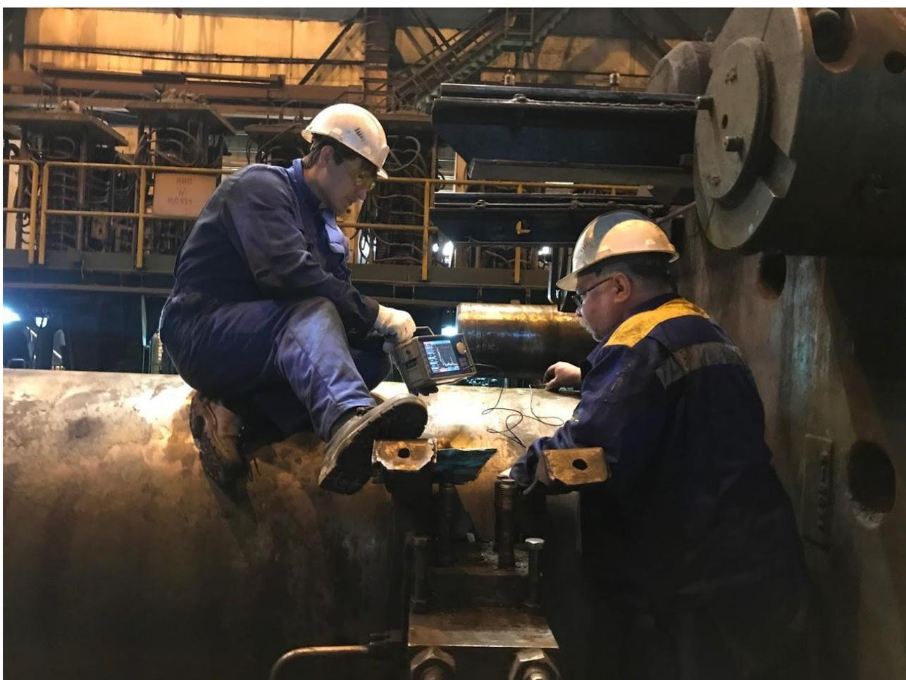
Рисунок 53.Проведение неразрушающего контроля методом УК специалистами II уровня Капускиным Ю.И. и Зуевым Е.А.
