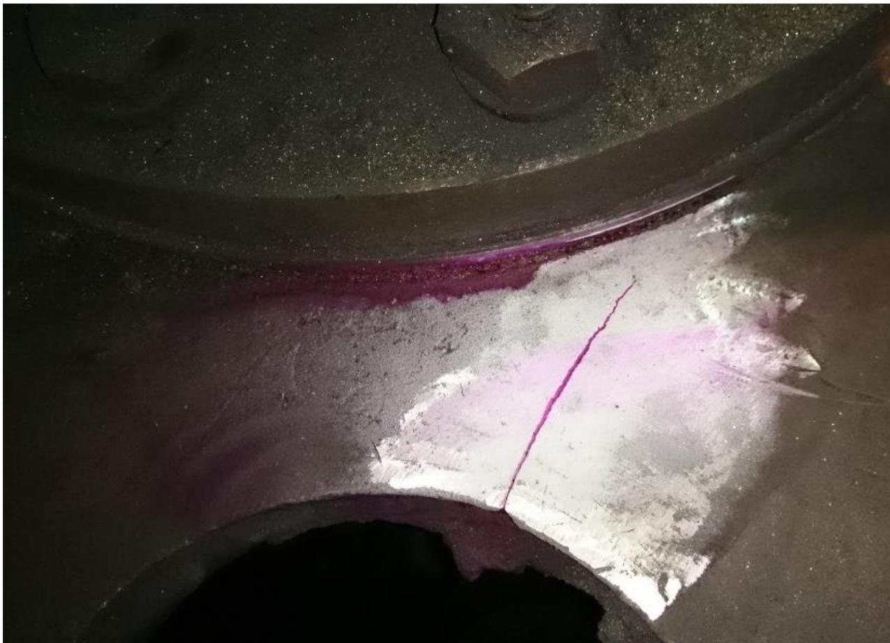
Рисунок 34. Трещина, обнаруженная с помощью капиллярного метода неразрушающего контроля
