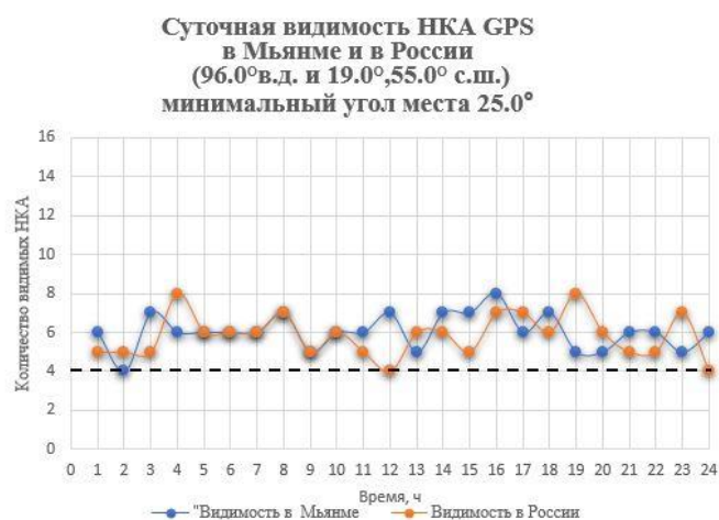
Рисунок 1.5 – Суточная доступность спутников ГЛОНАСС и GPS для точек Земной поверхности 96° в.д. и 55°, 19° с.ш. угол места 25°
