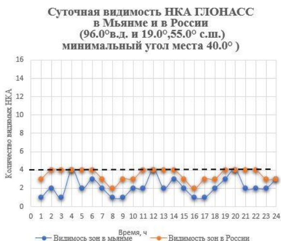
Рисунок 1.6 – Суточная доступность спутников ГЛОНАСС и GPS для точек Земной поверхности 96° в.д. и 55°, 19° с.ш. угол места 40°
