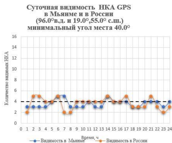
Рисунок 1.6 – Суточная доступность спутников ГЛОНАСС и GPS для точек Земной поверхности 96° в.д. и 55°, 19° с.ш. угол места 40°
