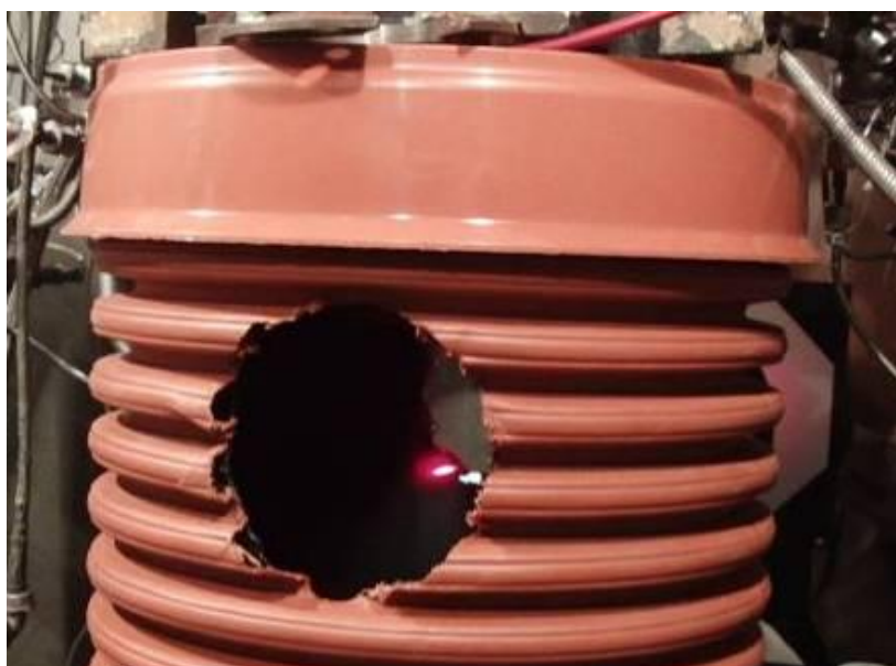
Рисунок 7. Внешний вид каплеуловителя с окном для лазерного луча.
