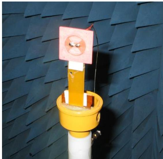
**Рис.5.3.** Печатная антенна «бабочка» в процессе измерения характеристик.
