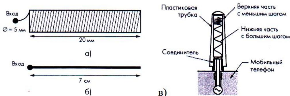
**Рис.1.1.** Вид спиральной (а) и четверть волновой (б) антенн на резонансную частоту 868 МГц; в) тип двухдиапазонной спиральной антенны.
