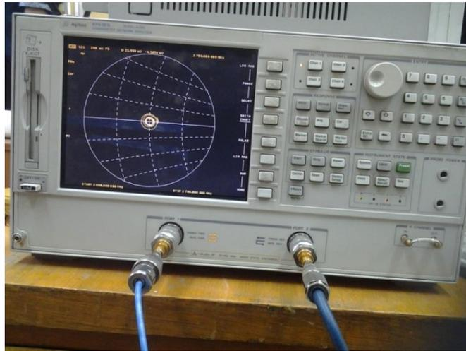
**Рис.5.2.** Прибор измерения характеристик печатной антенны «бабочка».
