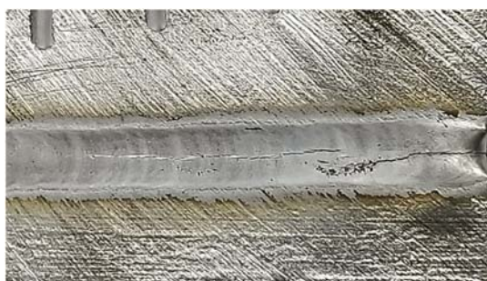
Рисунок 2 – Внешний вид образцов пробы «рыбий скелет» из исследуемого сплава Al-1Ca-5,5Zn-1,5Mg-0,5Mn
