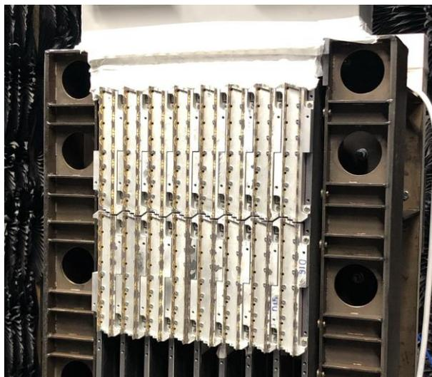
Рисунок 2.7 – Приемная ФАР X-диапазона, участвовавшая в эксперименте по оценке погрешности калибровки методом REV
