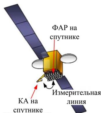
Рисунок 1.9 – Схематичное изображение калибровочной системы на спутнике
