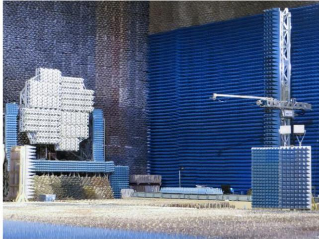
Рисунок 2.18 – Общий вид стенда при калибровке ФАР методом REV
