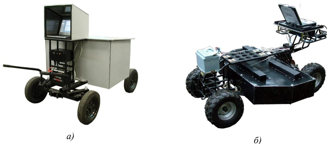
Рисунок 7 – Внешний вид многоканальных РПЗ подповерхностного зондирования, разработанных в рамках НИР «Водолей» (а) и ОКР «Водолей-Э1» (б).
