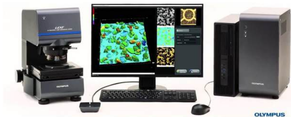
Рисунок 3.4 – Лазерный конфокальный сканирующий микроскоп Olympus LEXT OLS 5000
