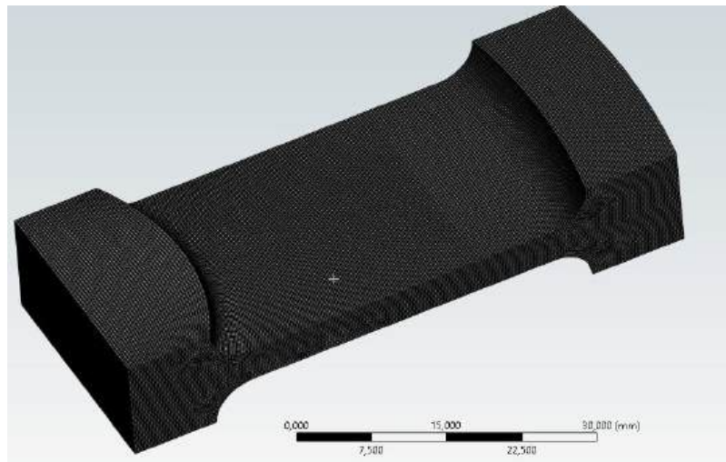
Рисунок 5.4 – Конечно-элементная модель образца-имитатора спинки РЛ
