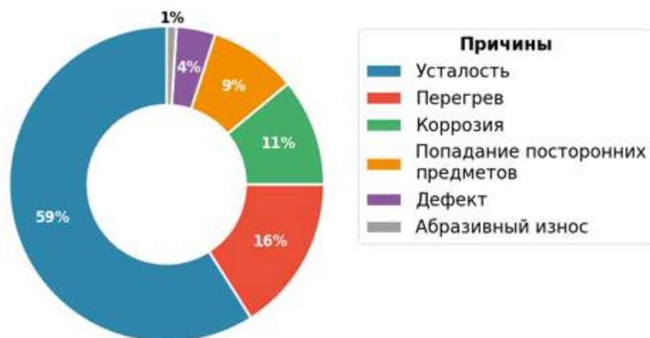
Рисунок 1.2 – Распределение причин разрушения для лопаток и дисков ГТД [33].
