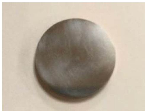
Рисунок 3.2 – Образец для исследования поверхностных отпечатков после однократных лазерных воздействий
