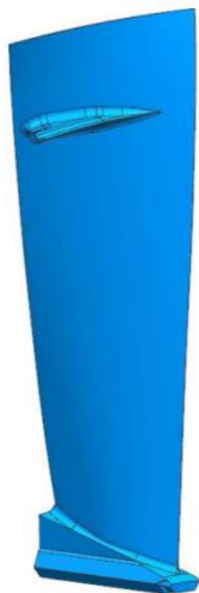
Рисунок 5.21 – Общий вид рабочей лопатки КНД из титанового сплава ВТ6
