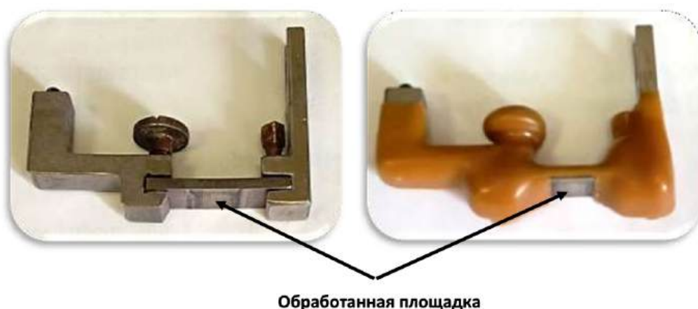
Рисунок 3.6 – Подготовка образца к электрохимическому травливанию поверхностного слоя при измерении поверхностных ОН механическим методом
