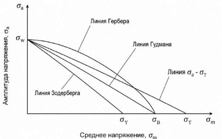
Рисунок 5.2 – Диаграмма усталостной прочности
