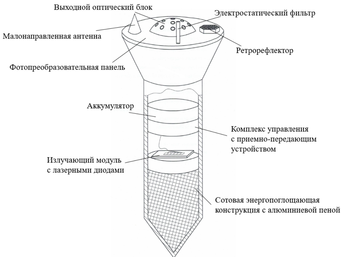
Рисунок 5 – Состав автономного оптического маяка-пенетратора:
