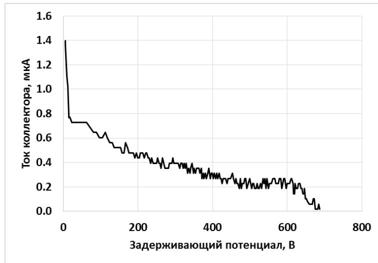
Рисунок 3.23 – Типичная тормозная характеристика электростатического ЭА в периферийной зоне струи
