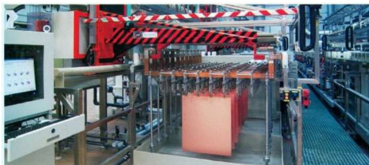
Рисунок 2 — Линия химического меднения ПП
