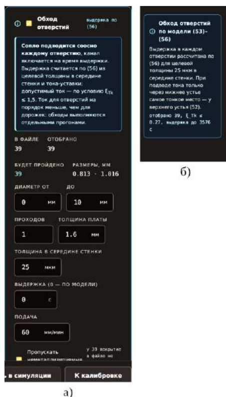
Рисунок 84 — Обход отверстий: а — параметры обхода; б — результат расчёта по (53)–(56)
