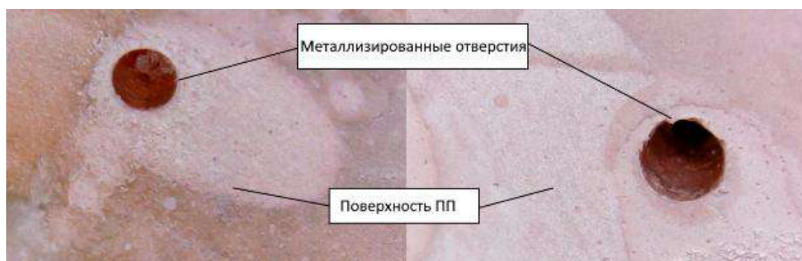
Рисунок 35 — Внешний вид заготовок после металлизации. Снято с 50-кратным увеличением. Справа – заготовка, активированная по графитовой системе, Слева – заготовка, активированная с помощью комплекса ГФМ.
