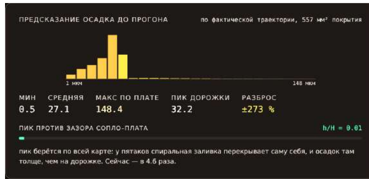
Рисунок 82 — Предсказание распределения толщины покрытия до начала металлизации
