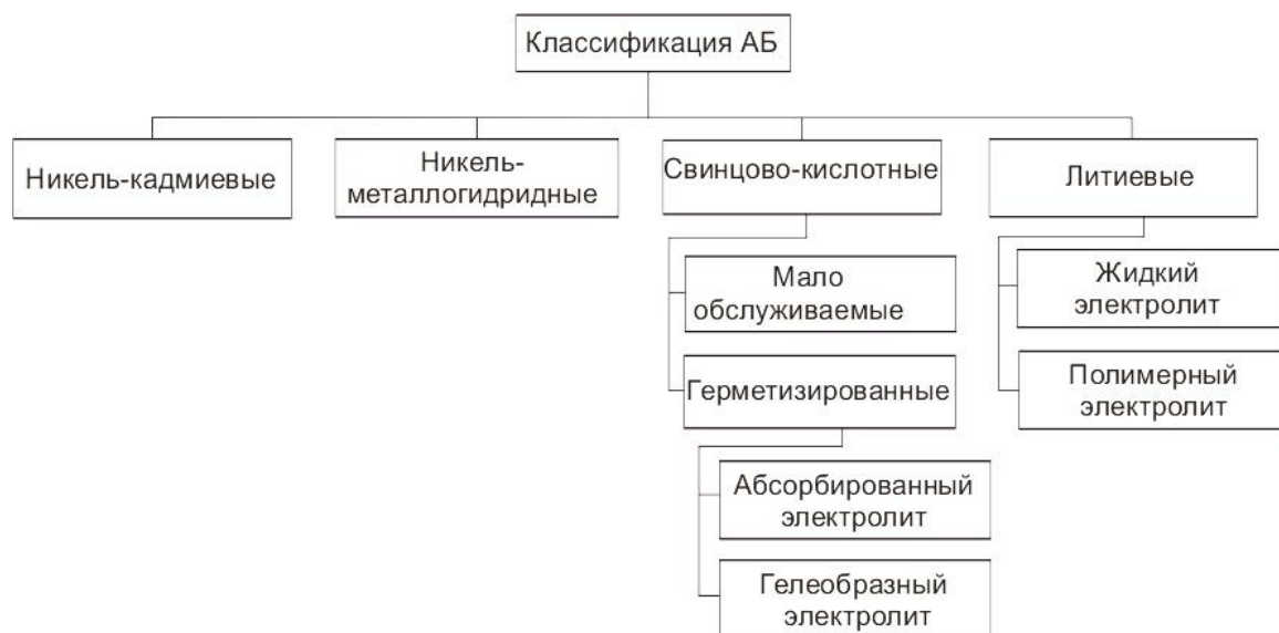
Рисунок 2.14. Классификация химических накопителей по типу электролита и уровню обслуживания
