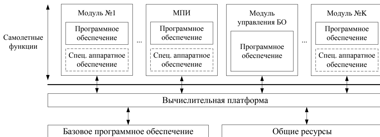
Рисунок 7 – Структурная схема вычислительной платформы в соответствии с концепцией распределенной ИМА
