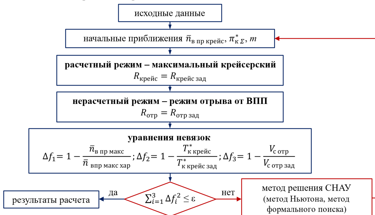
Рисунок 11 – Алгоритм определения проектных параметров двигателя
