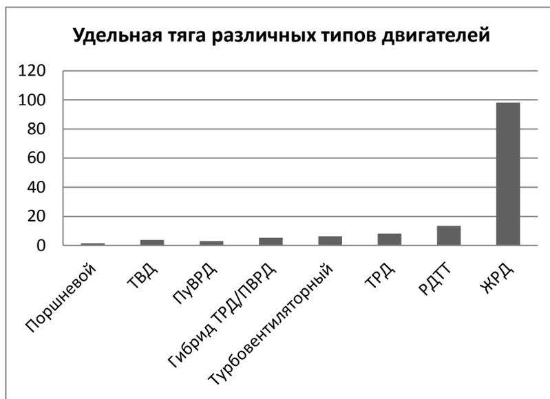
Рис. 1.5. Удельная тяга двигателей различных типов
