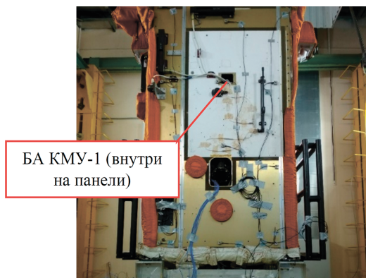
Рис. 3. Место замера, близкое к центру масс установки БА КМУ-1 (КМУ – компенсатор микроускорений, расположен внутри КА на панели)
