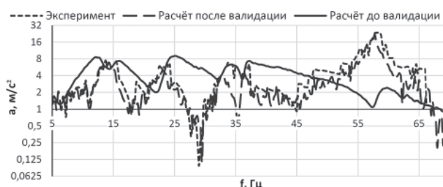
Рис. 8. Расчетные и экспериментальные виброускорения центра масс БА «Метеор»
