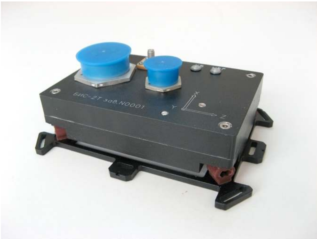
Рисунок 8 – Блок инерциально-спутниковый БНК БИСНС-2Т.
