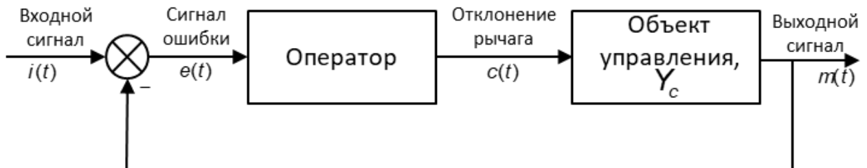
а) Структурная схема компенсаторного поведения
