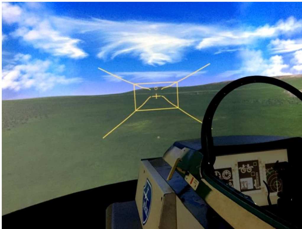
Рисунок 4.15 – Пилотажный стенд МАИ
