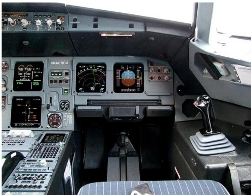
Рисунок 1.1 – Внешний вид боковой ручки самолета А-320 и ее расположение в кабине самолета
