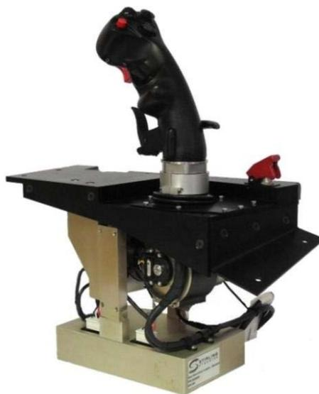
Рисунок 1.11 – Активная боковая ручка симулятора F-35 фирмы «Stirling Dynamics»
