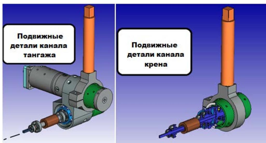
Рисунок 2.7 – Подвижные детали при работе БРУ
