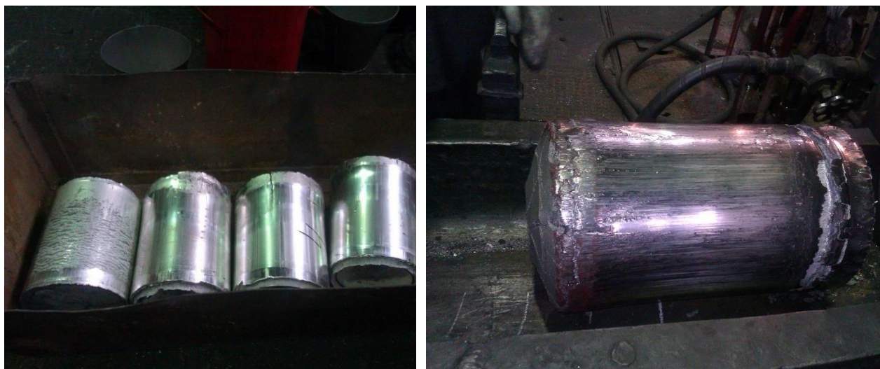
Рис. 5.9 Компактированные заготовки из гранул магниевого сплава МА14
