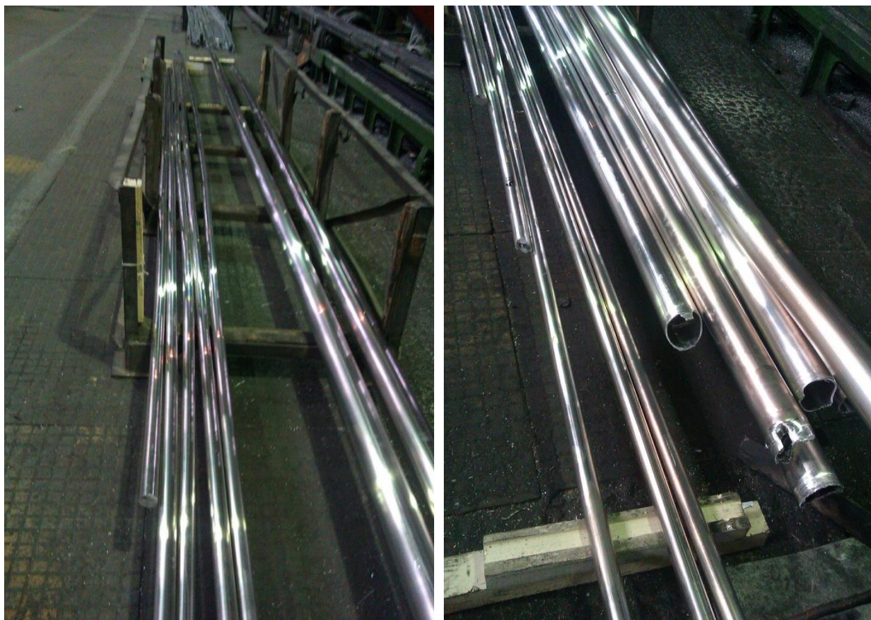
Рис. 5.9 Компактированные заготовки из гранул магниевого сплава МА14
