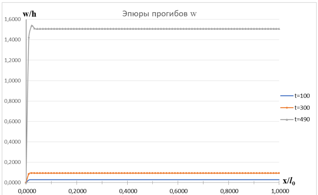
Рис. 4.22. Эпюры прогибов w при T_1=100^\circ\text{C} , T_1=300^\circ\text{C} и T_1=490^\circ\text{C}
