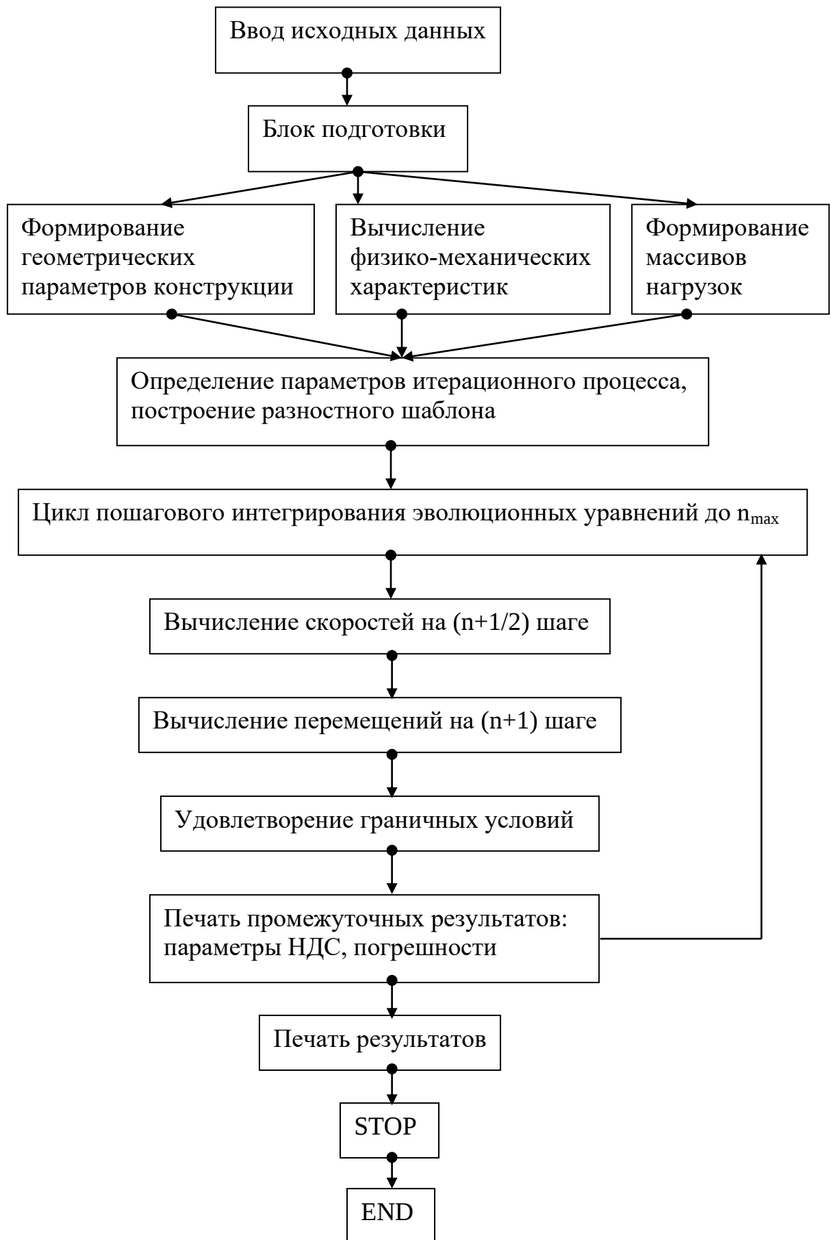
Рис. 3.2. Блок-схема программной реализации метода установления
