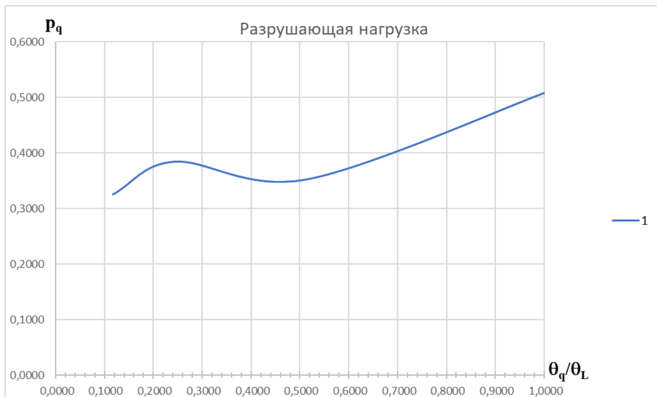
Рис. 4.17. Зависимость величины разрушающей нагрузки от области нагружения \theta_q сферической оболочки
