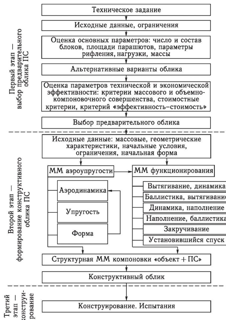
Рисунок 10 – Структурная схема системы автоматизированного формирования облика парашютной системы десантирования и спасения тяжёлых и сверхтяжёлых грузов [34, с. 174]
