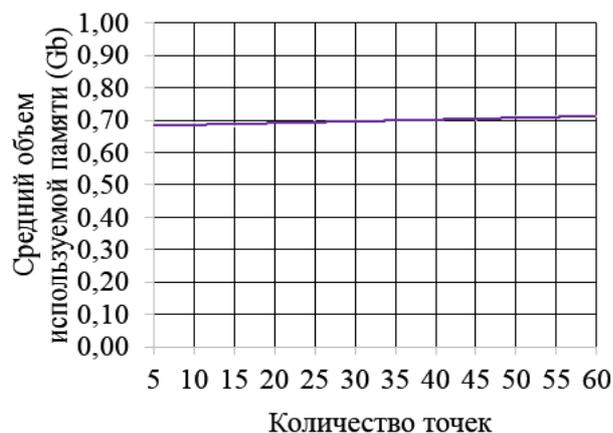
Рис. 4.6. Зависимость среднего объема используемой памяти от количества маршрутных точек - вариант 2
