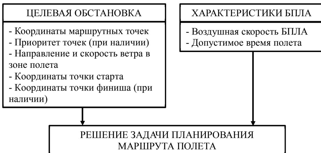
Рис. 1.4. Схема отражающая исходные данные и результат решения задачи планирования маршрута полета
