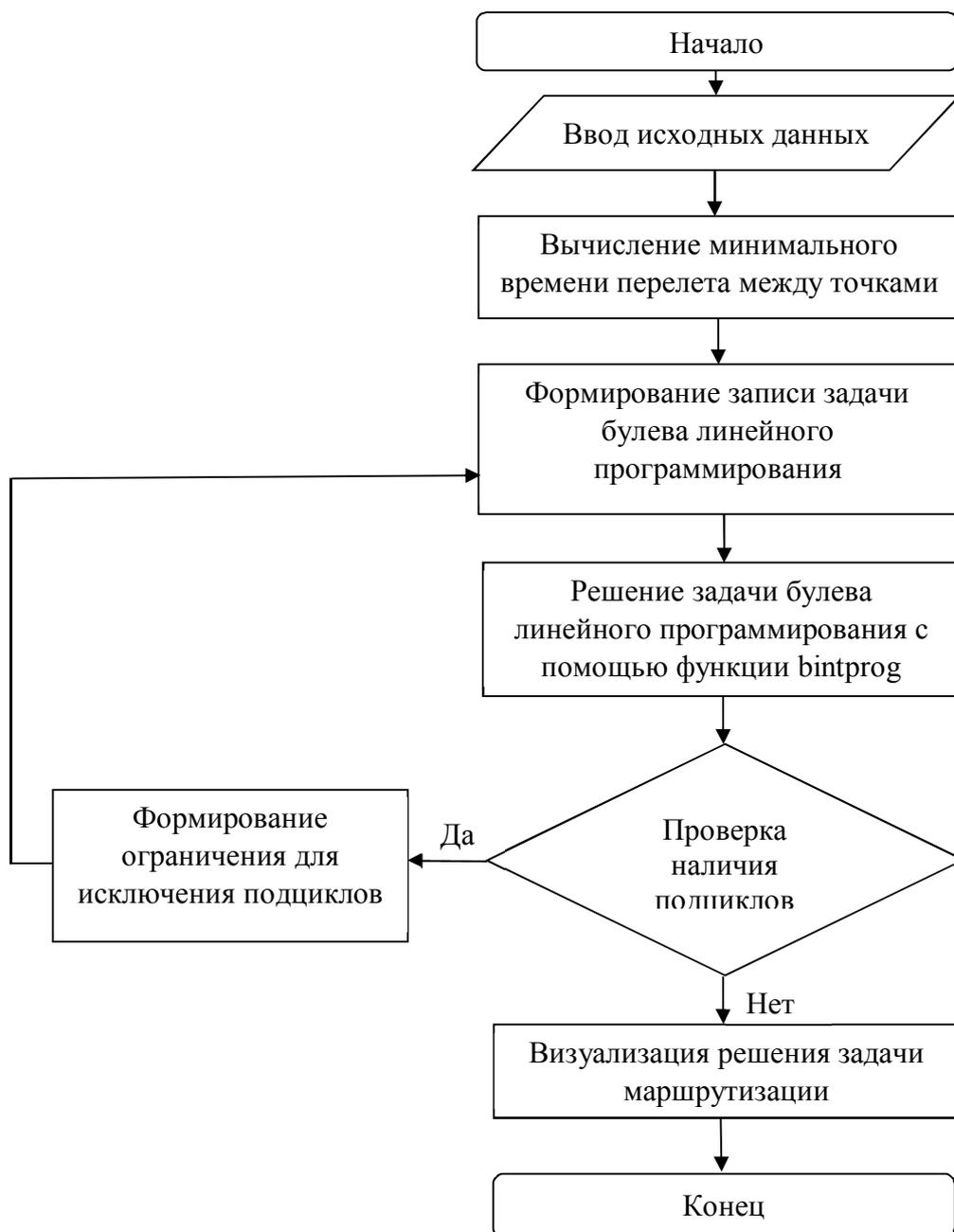
Рис. 4.4. Блок-схема алгоритма работы программного обеспечения маршрутизации полета БПЛА с использованием процедуры последовательного запрета подциклов
