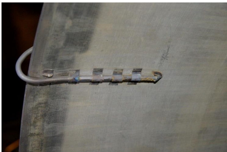
Рисунок 4.41 – Потемнение кромки сопла, возникшее при экспериментальном запуске.
