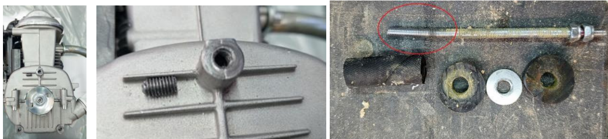
Рисунок 5 – Обрыв несущей шпильки, кусок шпильки, извлеченный из двигателя
