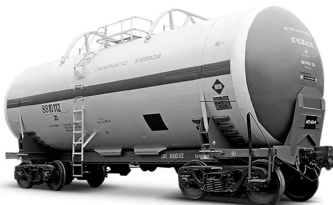
Рис. 3. Цистерна для железнодорожной транспортировки СПГ
