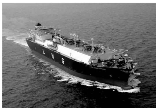
Рис. 2. Современный газовоз с мембранными танками
