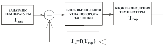
Рис. 5 - Алгоритм работы системы регулирования
