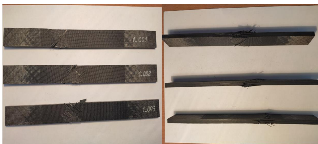
Рисунок 3.18 – Разрушенные образцы конструкции без наночастиц (ASTM D3039/ГОСТ Р 57745)
