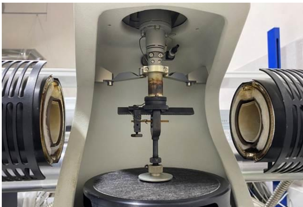
Рисунок 2.6 – Закрепление полимерного образца в измерительном модуле ДМА
