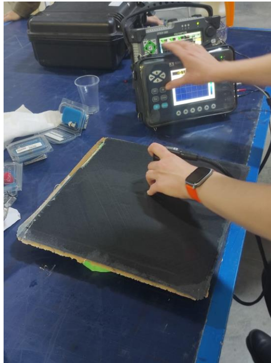
Рисунок 3.10 – Проверка панелей акустическим методом неразрушающего контроля
