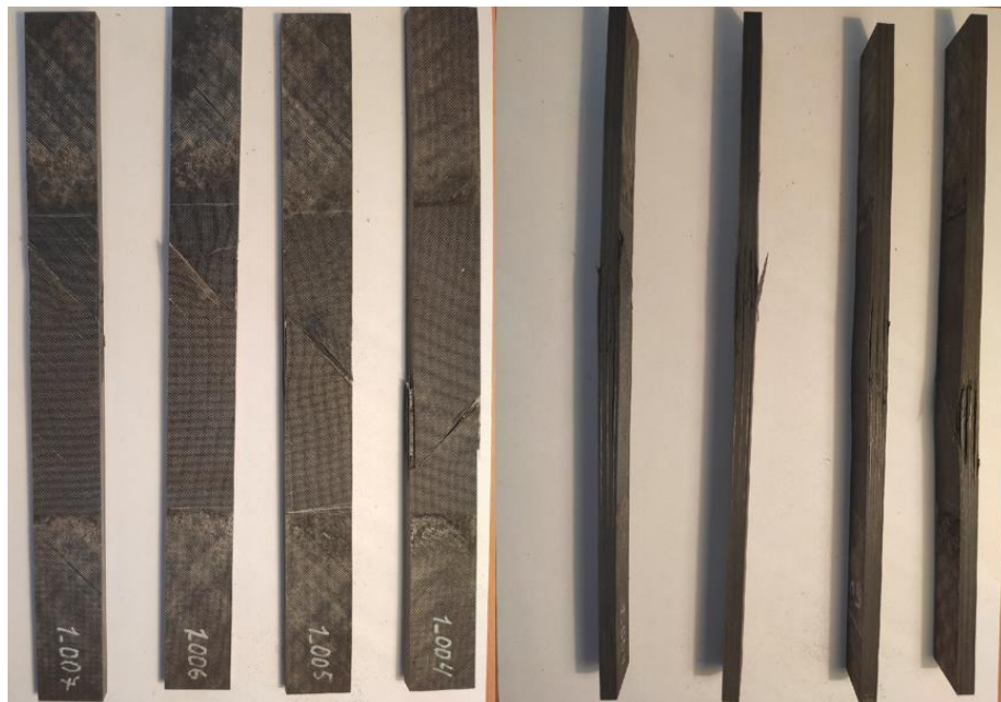
Рисунок 3.21 – Разрушенные образцы без наночастиц вследствие циклического нагружения
