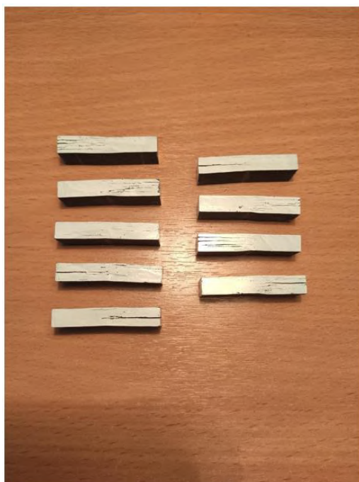
Рисунок 3.14 – Разрушенные образцы: а – без наночастиц, б – с наночастицами
