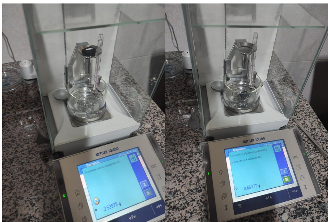
Рисунок 3.32 – Гидростатические весы. а - образец в воздухе, б - в воде
