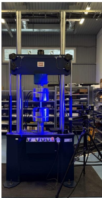
Рисунок 4.10 – Испытательная машина для механических испытаний с системой Корреляции Цифровых Изображений
