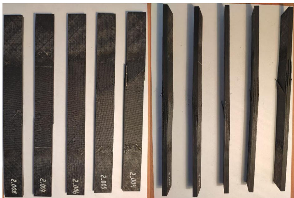
Рисунок 3.22 – Разрушенные образцы с наночастицами вследствие циклического нагружения
