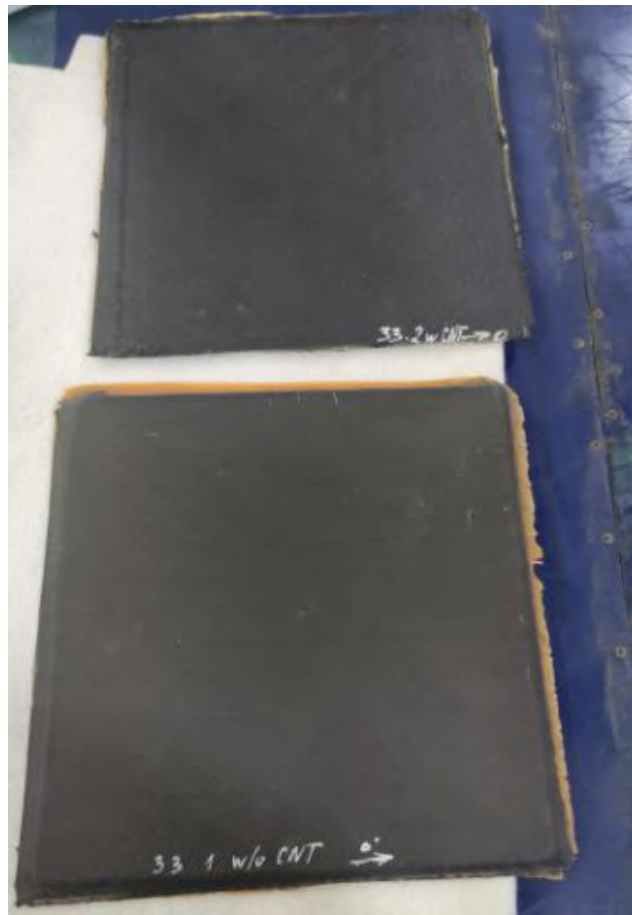
Рисунок 3.9 – Панели, полученные методом вакуумной инфузии
