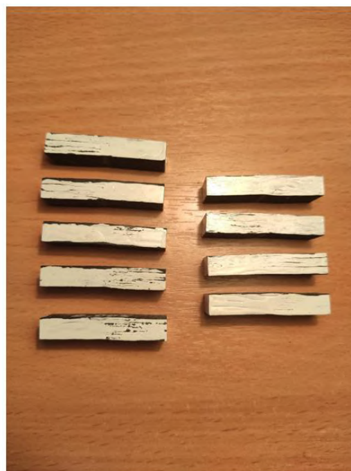
Рисунок 3.14 – Разрушенные образцы: а – без наночастиц, б – с наночастицами
