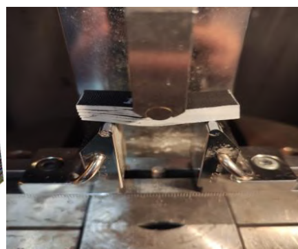
Рисунок 4.5 – Натурный элементарный образец композиционного материала после испытаний на сдвиг по стандарту ASTM D2344/ГОСТ Р 57745
