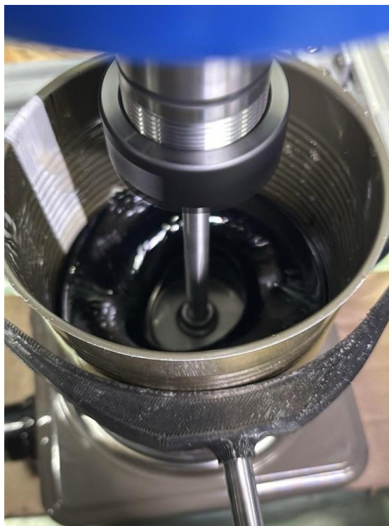
Рисунок 2.8 – Формирование стабильного тороидального потока при диспергировании (2800 об/мин)
