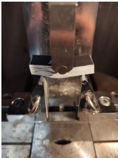
Рисунок 3.13 – Снимок разрушенного образца в испытательной машине (ASTM D2344/ГОСТ Р 57745)
