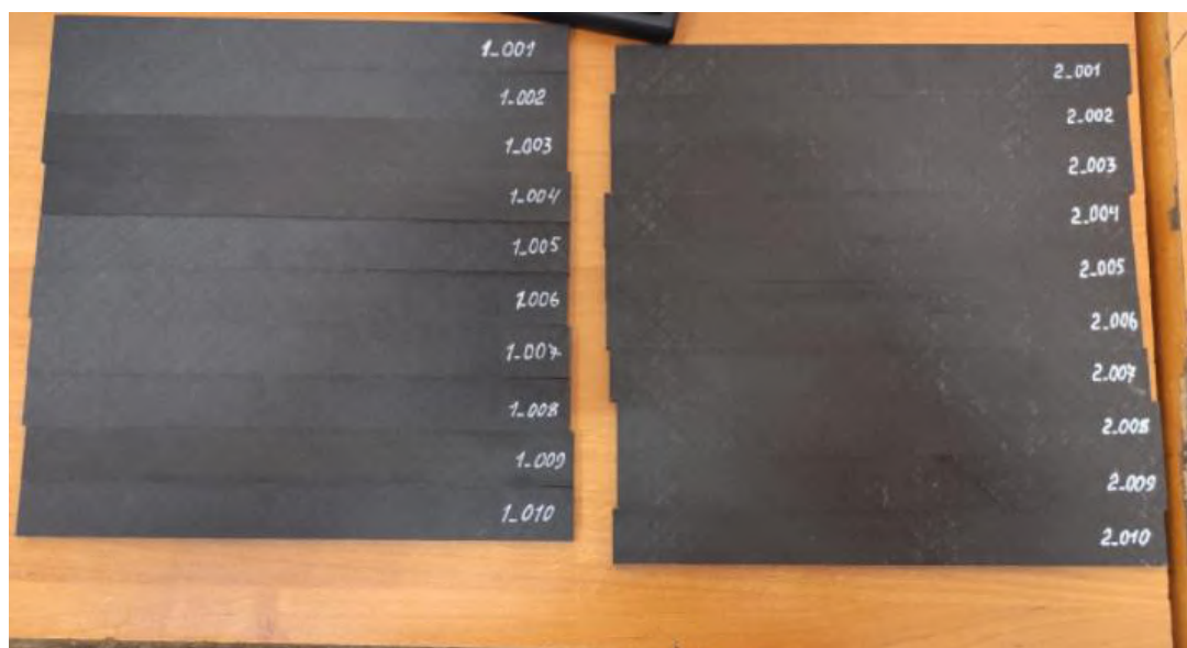
Рисунок 3.12 – Элементарные образцы для испытаний на статическое и циклическое растяжение
