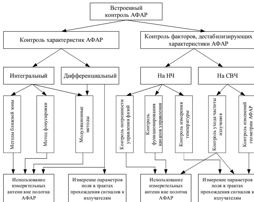
Рис.2 Методы контроля характеристику и технического состояния АФАР и ее КОМПОНЕНТ
