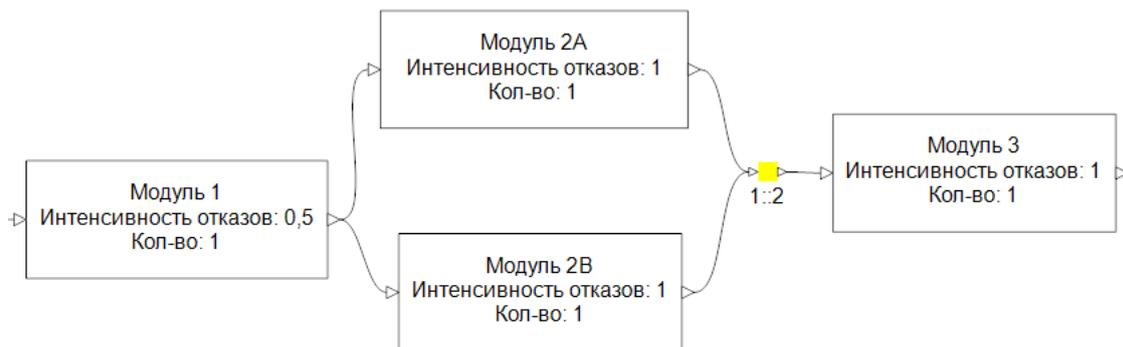
Рис.1. Укрупненная блок-схема надежности АФАР с резервированием
