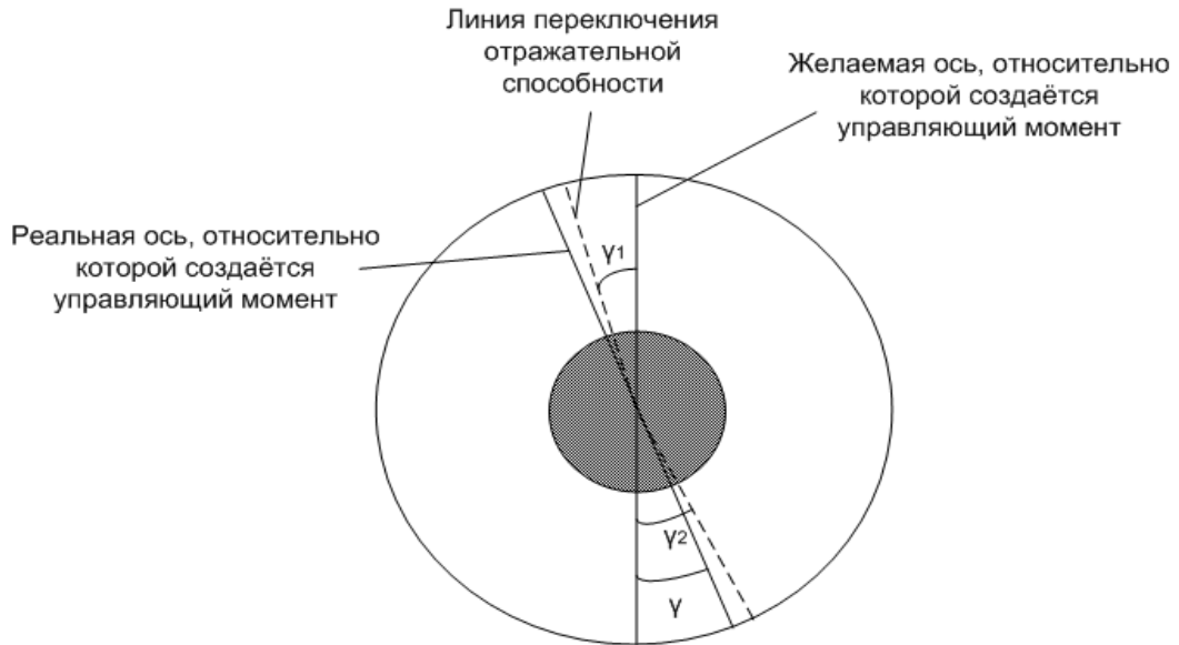
Рисунок 3.1.1 – Расхождение реальной и желаемой оси, относительно которой создаётся управляющий момент
