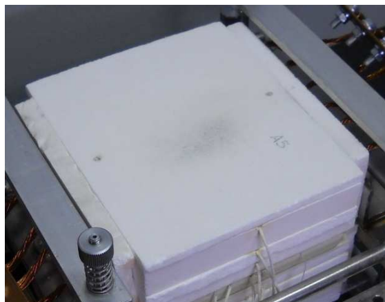
Рис. 4.8 Дополнительная электроизолирующая пластина
