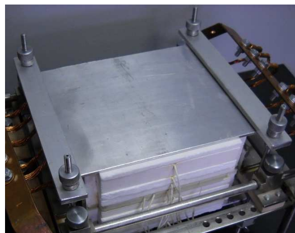
Рис. 4.10 – Верхнее прижимное устройство модуля с пружинами
