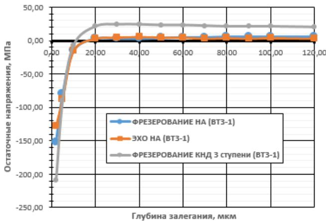
Рисунок 8. Сравнение остаточных напряжений, полученных на лопатке направляющего аппарата после ЭХО и фрезерования пера.
