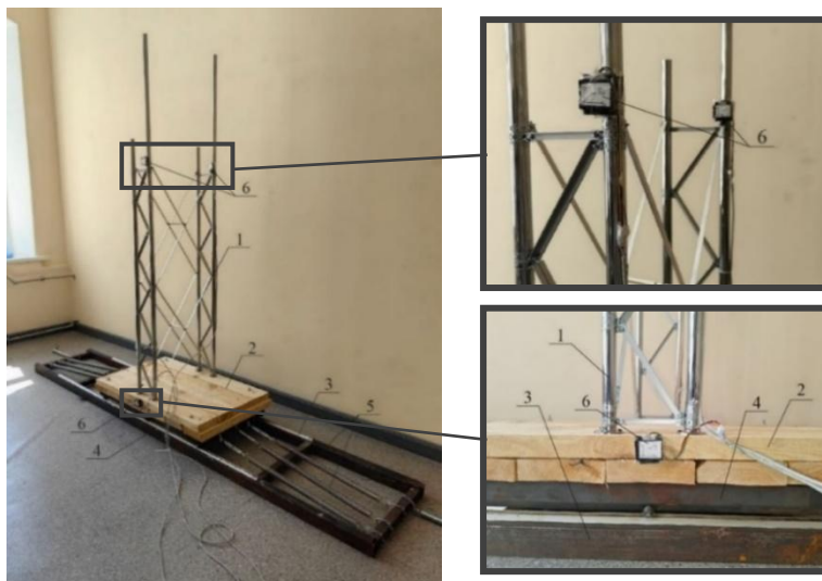
Рис. 8. Экспериментальная установка для проведения исследования свободных затухающих колебаний модели каркаса конструкции для эксплуатации подъемно-транспортных машин:
