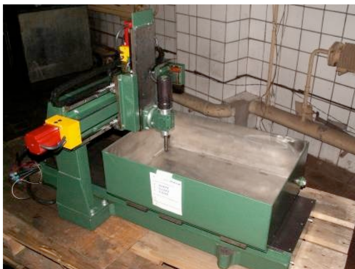
Рис. 8. Общий вид установки для очистки сопловых блоков.
