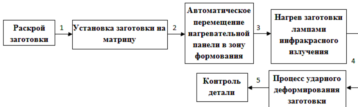
Рис. 1. Схема технологического процесса изготовления листовых деталей из труднодеформируемых сплавов
