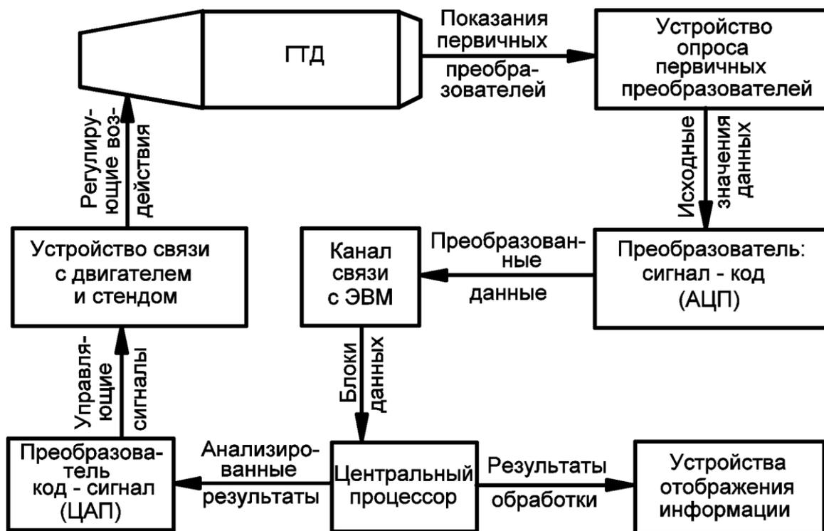
Рис.1. Типовая схема работы автоматизированной информационно – измерительной системы
