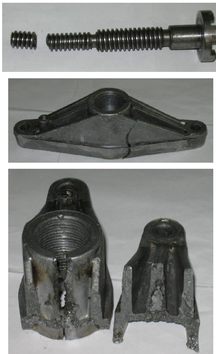
Рис. 1.4. Примеры разрушения элементов силовых конструкций, применяемых в энергетическом машиностроении
