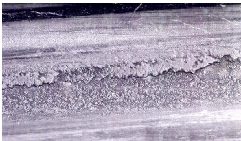
Рис. 1.3. Износ канала трубопровода из стали 15ГС вследствие воздействия рабочей среды
