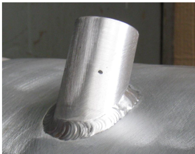
Рис. 6.9. Сварной узел натурной конструкции подпиточного бака
