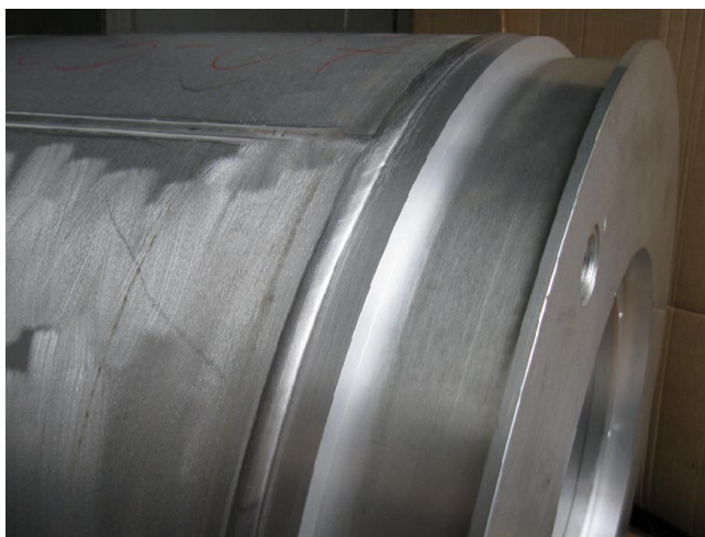
Рис. 1.5. Обечайка подпиточного бака с перекрестными сварными швами
