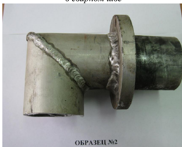
Рис. 7.3. Образец №2 («фланец») для исследования остаточных напряжений в сварном шве
