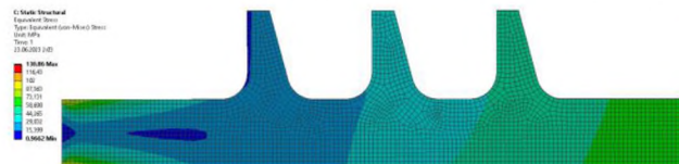
Рисунок 13 – Эквивалентные напряжения по Мизесу
