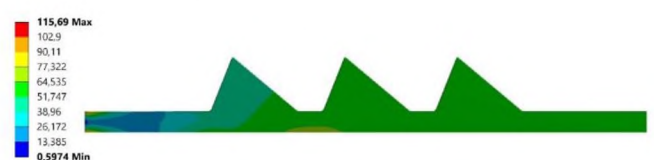
Рисунок 13 – Эквивалентные напряжения по Мизесу
