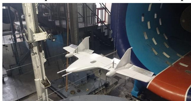
Рисунок 1 – Определение аэродинамических характеристик исследуемого БПЛА
