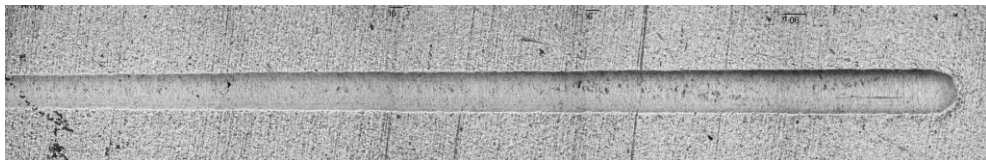
Рисунок 4.12 – График зависимости глубины вдавливания от нагрузки, совмещенный с изображением полученной при тестировании царапины для образца, подвергнутого ионному азотированию при 500°C
