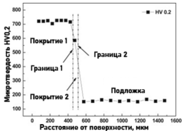
Рисунок 1.14 – Изменение микротвердости образца ТА2 с лазерной наплавкой по направлению от поверхности покрытия к подложке
